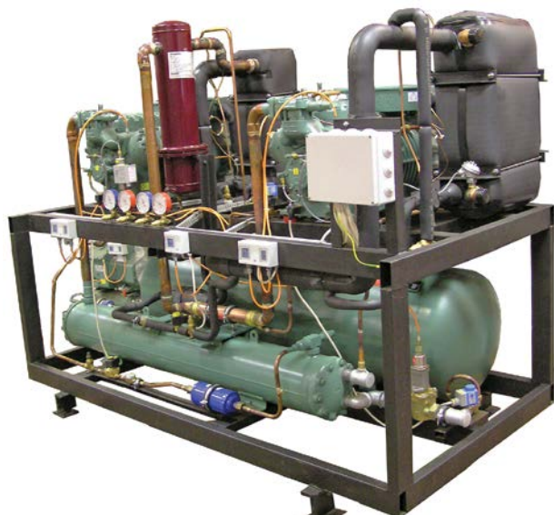
Двухкаскадная холодильная установка для охлаждения хладагента до -80°С
