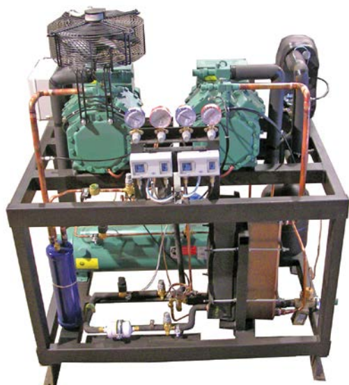
Каскадная холодильная установка для охлаждения хладагента до -82°С
