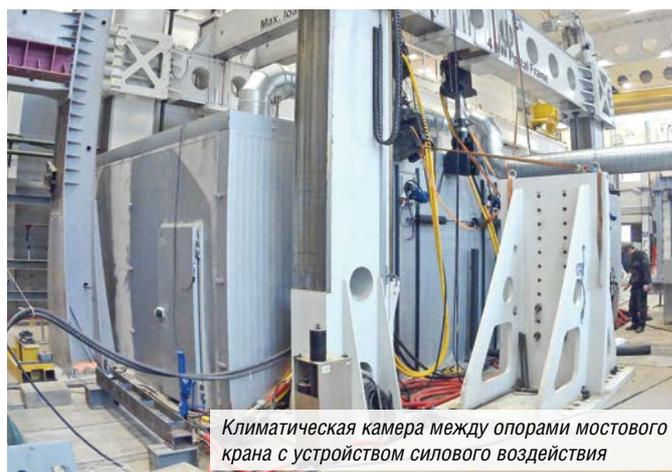
Климатическая камера между опорами мостового крана с устройством силового воздействия
