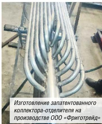
Изготовление запатентованного коллектора-отделителя на производстве ООО «Фриготрейд»
