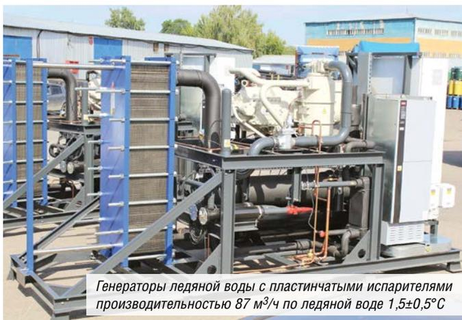
Генераторы ледяной воды с пластинчатыми испарителями производительностью 87 м<sup>3</sup>/ч по ледяной воде 1,5±0,5°С
