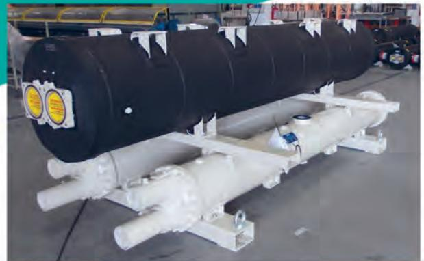
Сборка кожухотрубных теплообменников в единый блок
