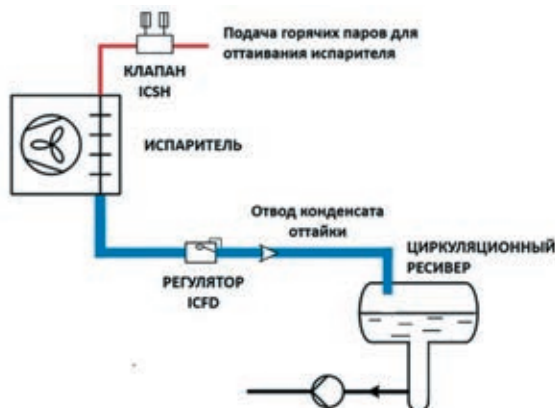
Рис. 1. Применение поплавкового регулятора ICFD
