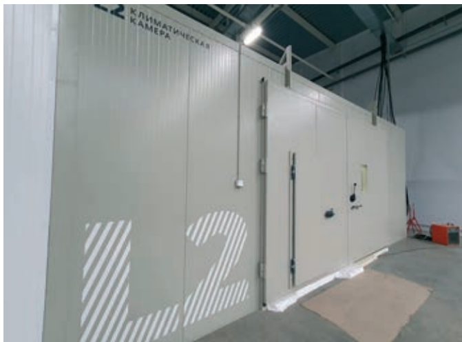
Внешний вид климатической камеры ФРИГОДИЗАЙН® серии КИ-90 с распашными воротами
