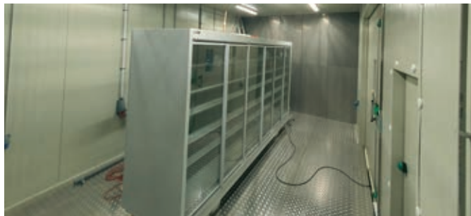
Холодильная витрина загружена в камеру для испытаний
