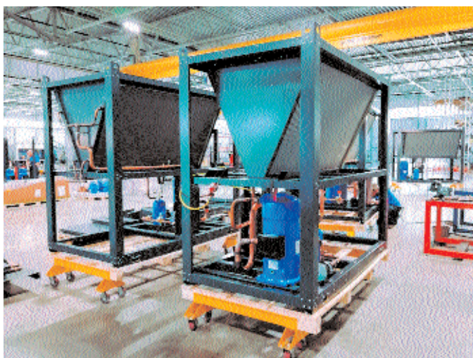
Линия сборки компрессорно-конденсаторных блоков
