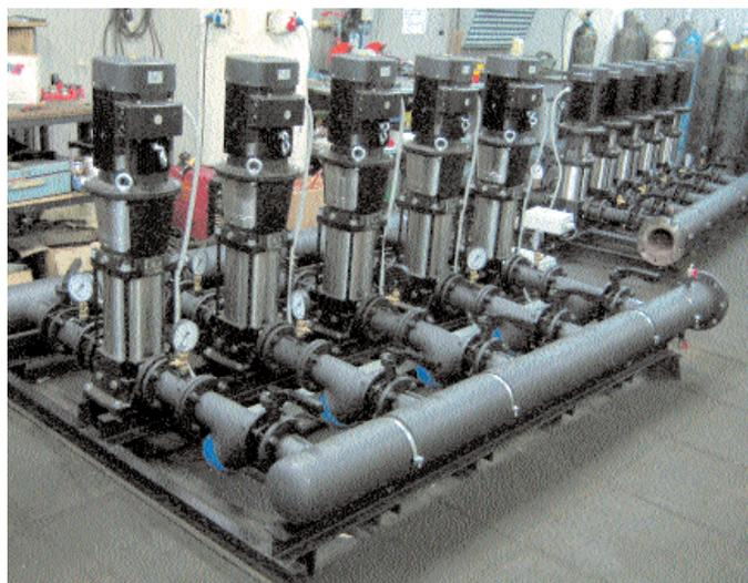
Сборка установок охлаждения жидкостей для ОАО «Синтез» на компрессорах J&E Hall и гидромодулей на производственном участке «Фригодизайн»
