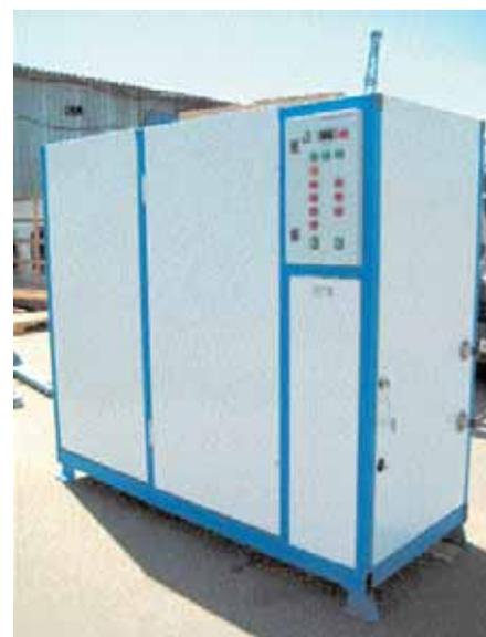
Чиллер с гидромодулем в защитном кожухе для охлаждения станка в ОАО «Биосинтез»
