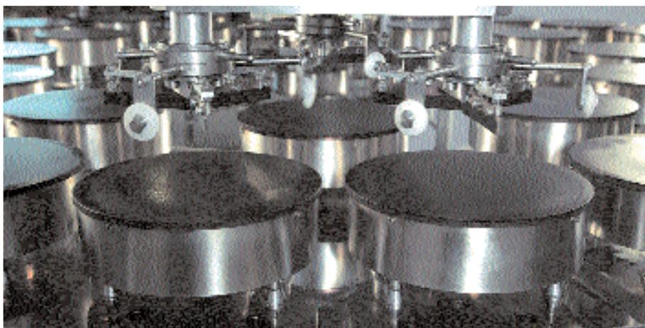
один человек. Линия полностью автоматизирована. Автоматикой контролируются точность дозирования ( $\pm 1$  гр), зонированный нагрев при двухсторонней обжарке, масса блина 50-70 гр, его диаметр от 10 до 25 см, толщина 2 мм.
